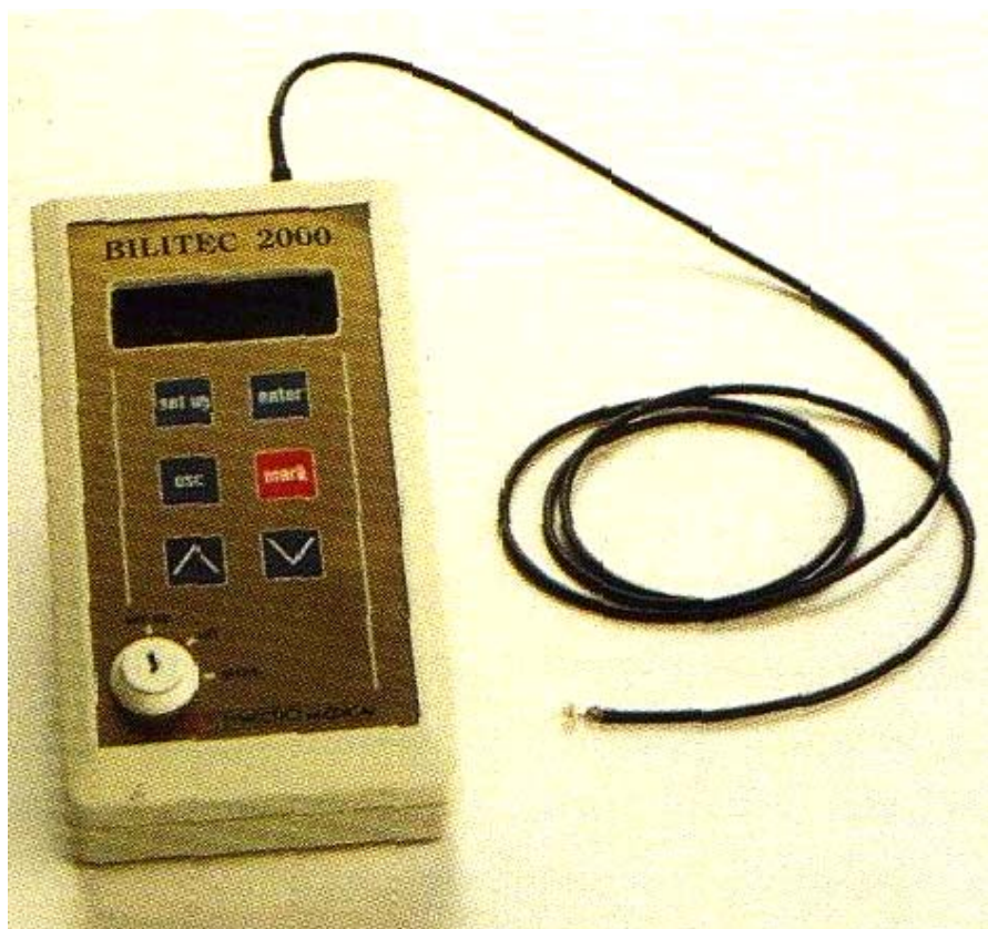
Рисунок 4 Портативный аппарат для билиметрии «Билитек 2000» фирмы «Synectics» (Швеция)
