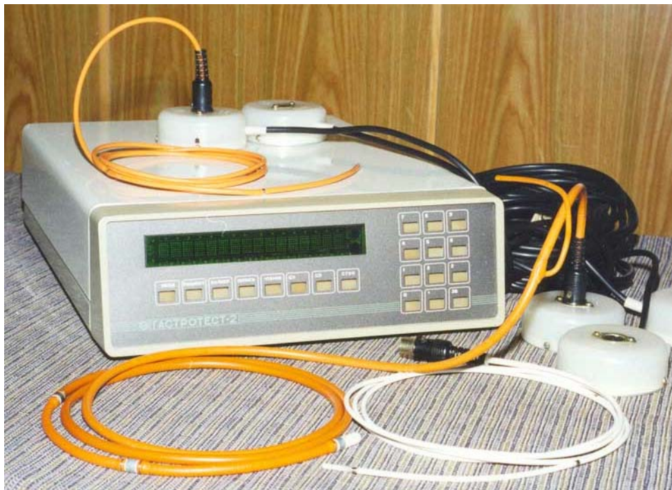
Рисунок 7 Ацидогастрометр "Гастротест" для динамического исследования кислотности верхних отделов ЖКТ одновременно у пяти пациентов
