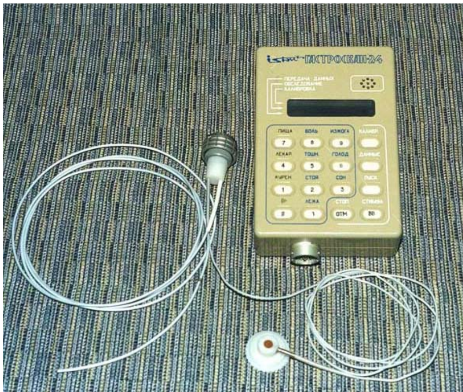
Рисунок 9 Компьютерная система "Гастроскан-24" для точного мониторинга кислотности верхних отделов ЖКТ
