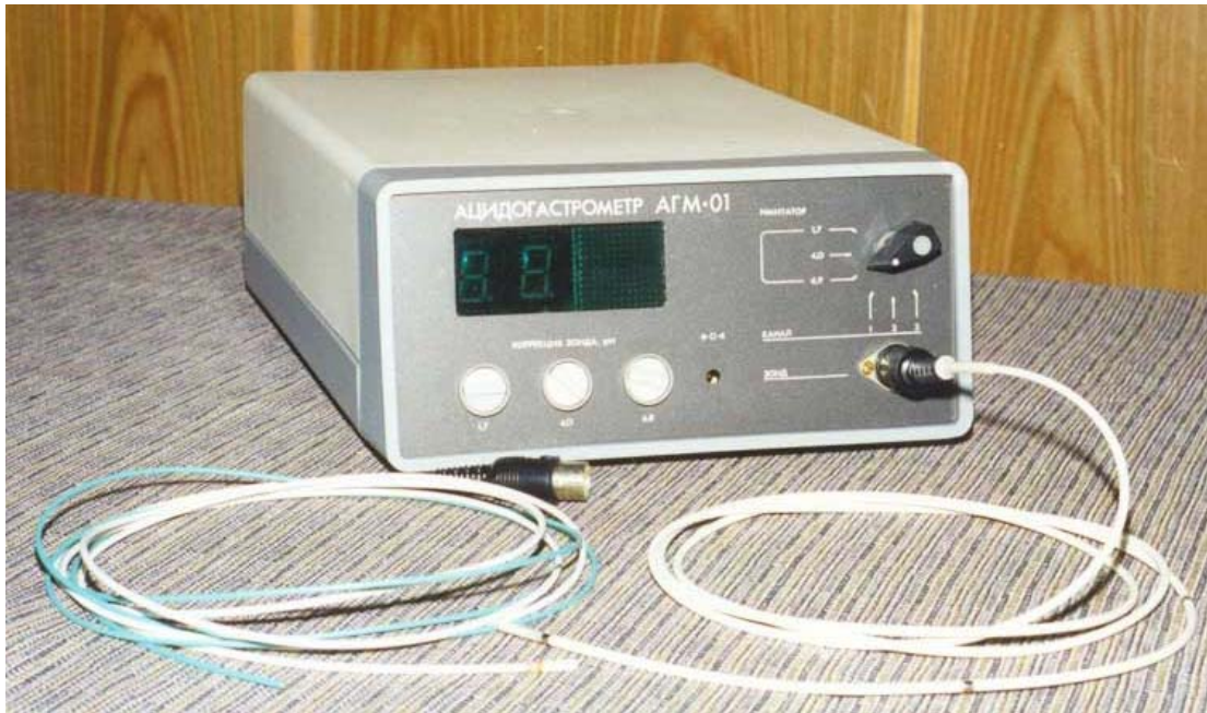
Рисунок 6 Ацидогастрометр АГМ-01 для непосредственной рН-метрии верхних отделов ЖКТ
