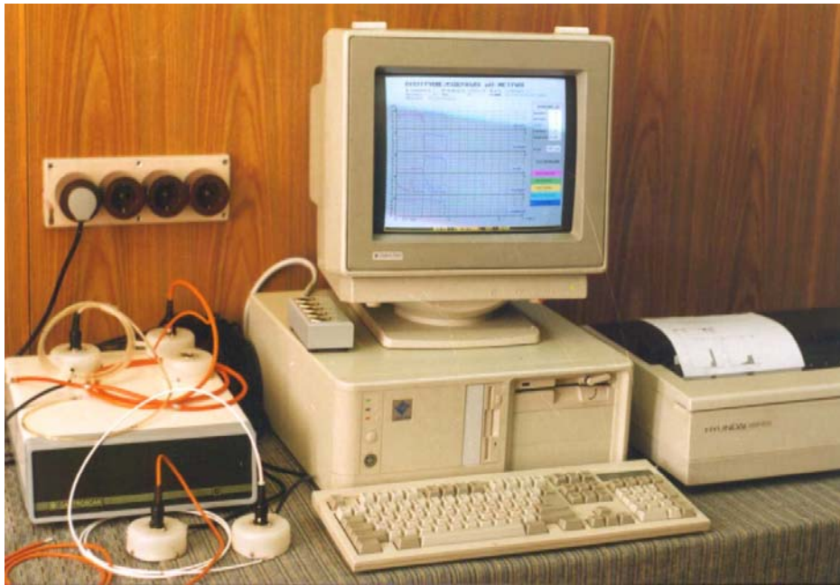
Рисунок 8 Компьютерная система "Гастроскан-5" для рН-метрии и диагностики состояния верхних отделов ЖКТ одновременно у пяти пациентов
